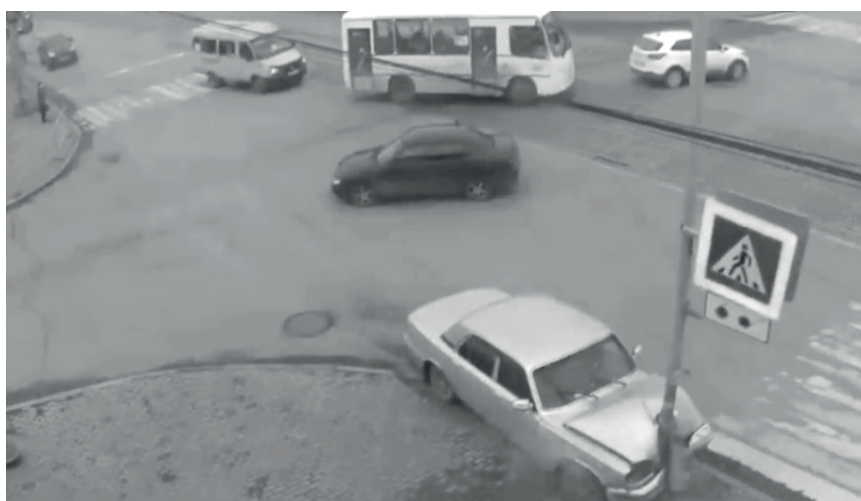
Рисунок 5 — Результат возникшей аварийной ситуации после маневра «объезда» автомобилем «Волга» (серебристого цвета) автомобиля «ВАЗ-2110» (черного цвета)
